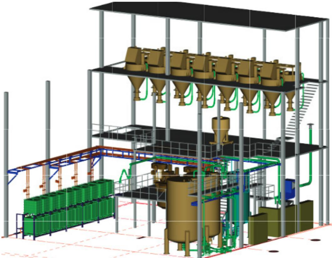
Процесс производства жидкой продукции (красок, штукатурок и грунтовок) представлен на фото.
