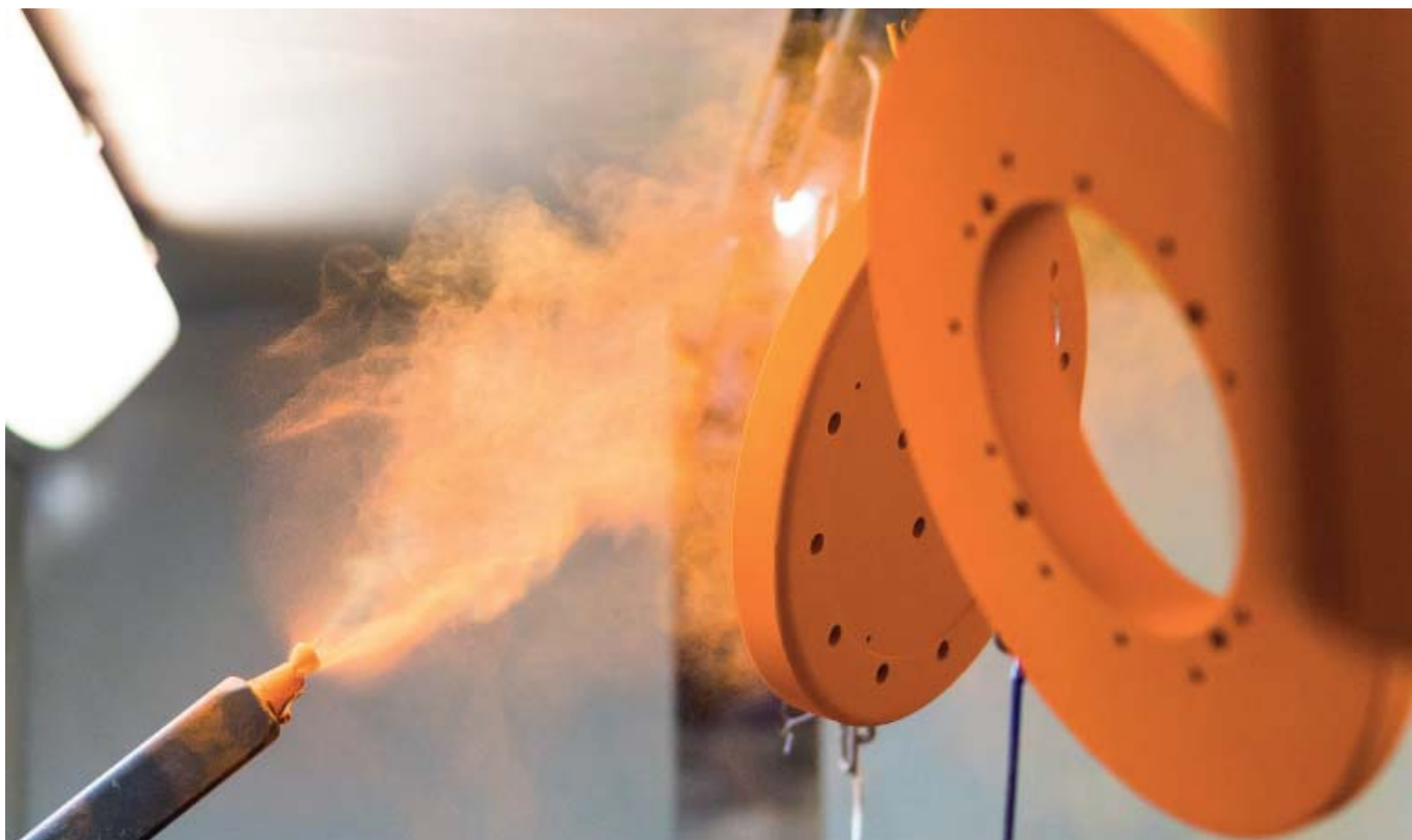
Фото. 2. Порошковая покраска с использованием систем REDOX значительно повышает коррозионную стойкость окрашиваемых деталей.
