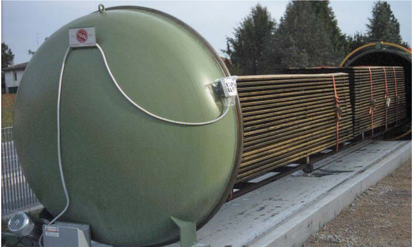
Фото. Просочування деревини під тиском в автоклаві
