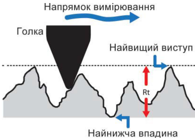
Фото. 3. Метод вимірювання шорсткості з допомогою рухомої голки профілометра
