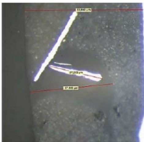
Фото. 6. Пігменти в порошковому покритті після екструзії. Більшість була zdeформована внутрішніми силами зсуву.
