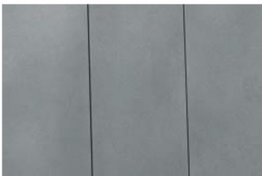
Фото. 3. Тіні і смуги через неоднорідний розклад металевого пігменту.
