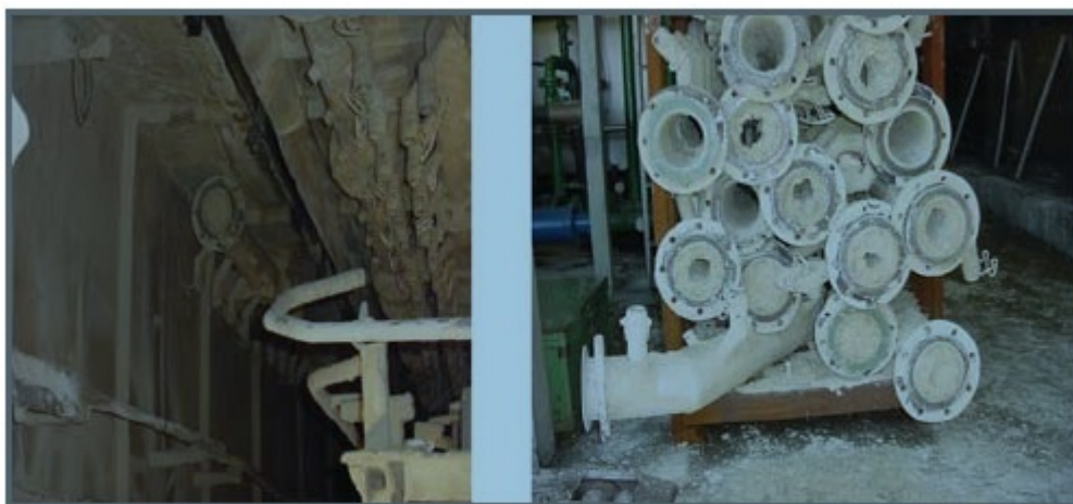
Шлам, образующийся в процесса фосфатирования
