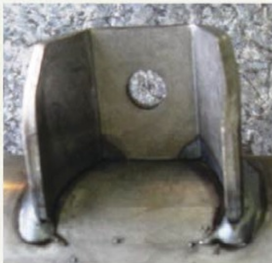
После обработки: цинкфосфатирование с нейтральным травлением
