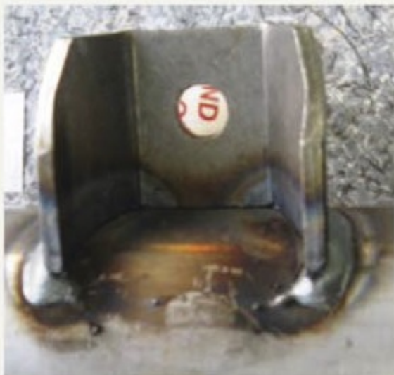
Перед обработкой: поверхность с окислами после сварки
