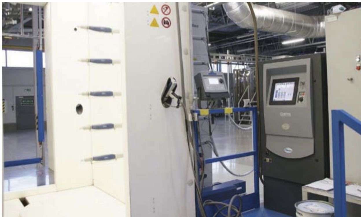
Блок управління iControl (справа) повністю контролює процес фарбування.
