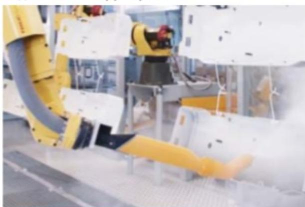
Рисунок 2. Пистолет с соплом под углом 45° для осевого подключение к руке робота.
