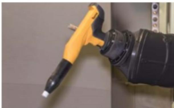
Рисунок 1. Пистолет с угловым смещением для подключения к руке робота.
