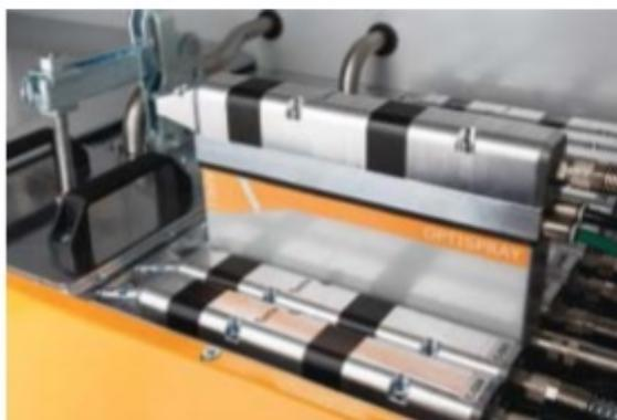
Рисунок 5. OptiSpray - технология подачи порошка плотной фазы. Такие насосы применяются, если требуется повторяемое нанесение покрытий самого высокого качества.
