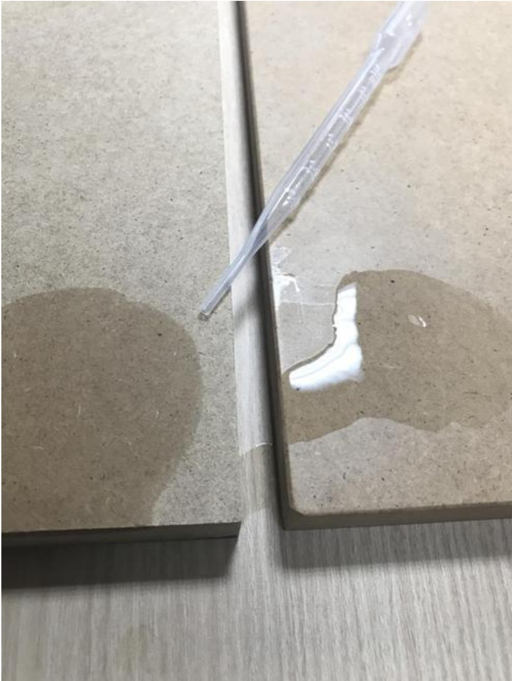
Можно самим убедиться в этом, проведя достаточно простой тест. Возьмите 2 образца МДФ, на один из них нанесите грунт-изолятор, отложите его на 1 час (это его период сушки), а второй оставьте необработанным. По истечении 1 часа оба образца отшлифуйте, как и положено по технологии.
