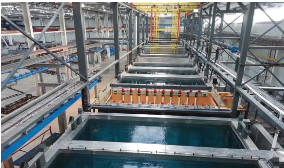
Фото. 4. Катафорезна тактова лінія фарбування методом занурення в ванни для компанії
