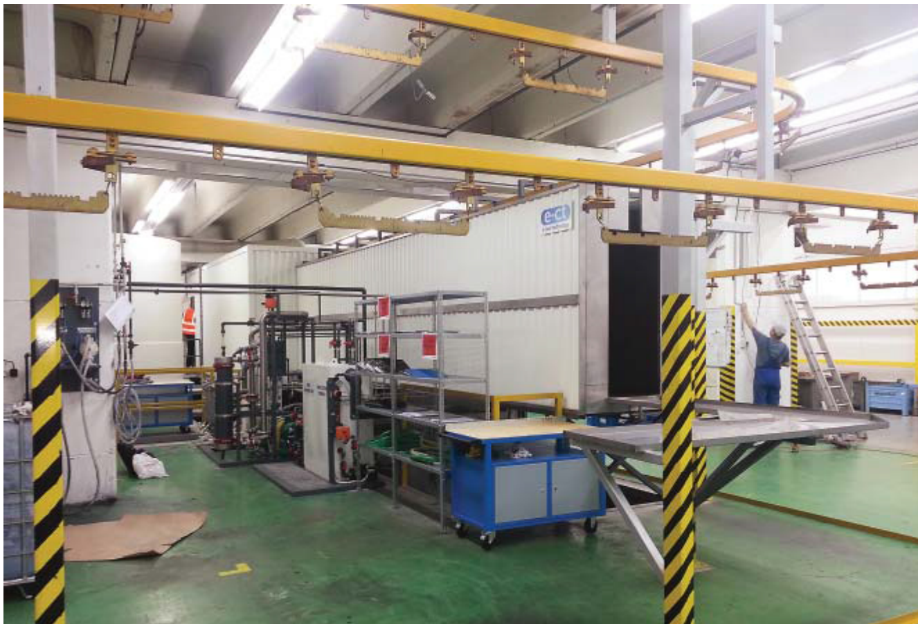
Фото. 3. Катафорезна безперервна лінія для компанії Matador.
