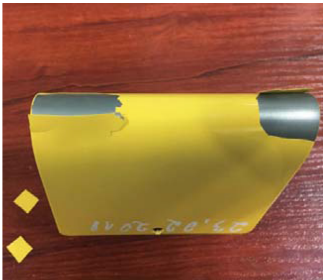
Фото. 2. Тестування на згинання – неполімеризоване покриття.
