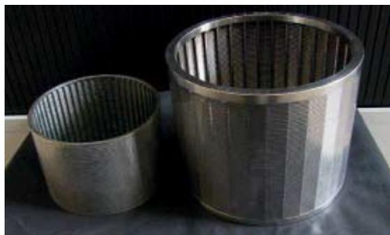
Рис. 3: Сравнение сит двух различных мельниц SFVCR 200 (слева), MMX 3 (справа), большая площадь обеспечивает большую производительность.
