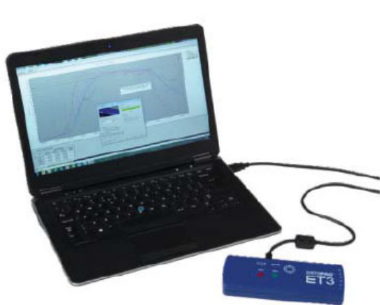
Система DATAQAQ, для измерения температурного режима в печи полимеризации
