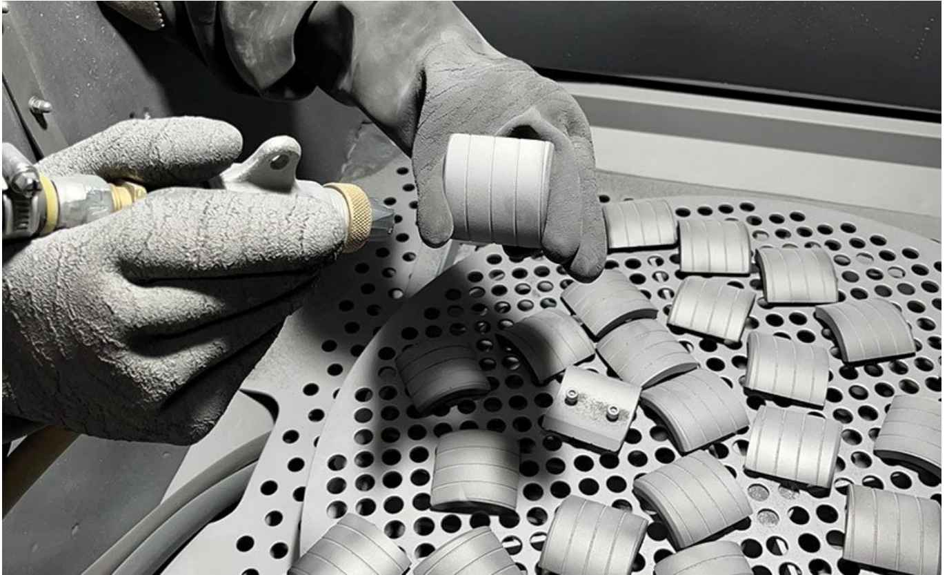
Фото. 1. Вигляд зсередини камери для дробоструминної обробки стисненим повітрям
