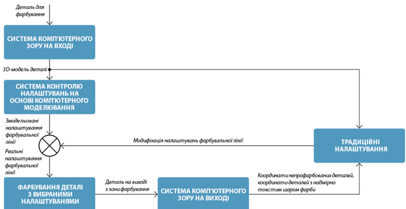
Рис. 1. Структура інтегрованої системи контролю налаштувань автоматичної лінії порошкового фарбування
