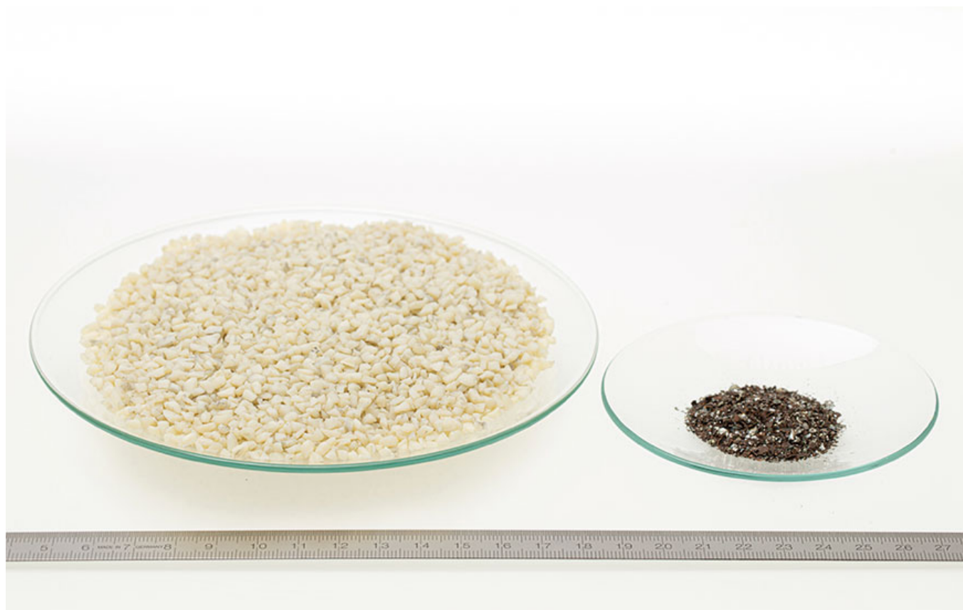
Фото. 70-80% отриманого матеріалу становить пластик, придатний для безпосереднього повторного використання.
