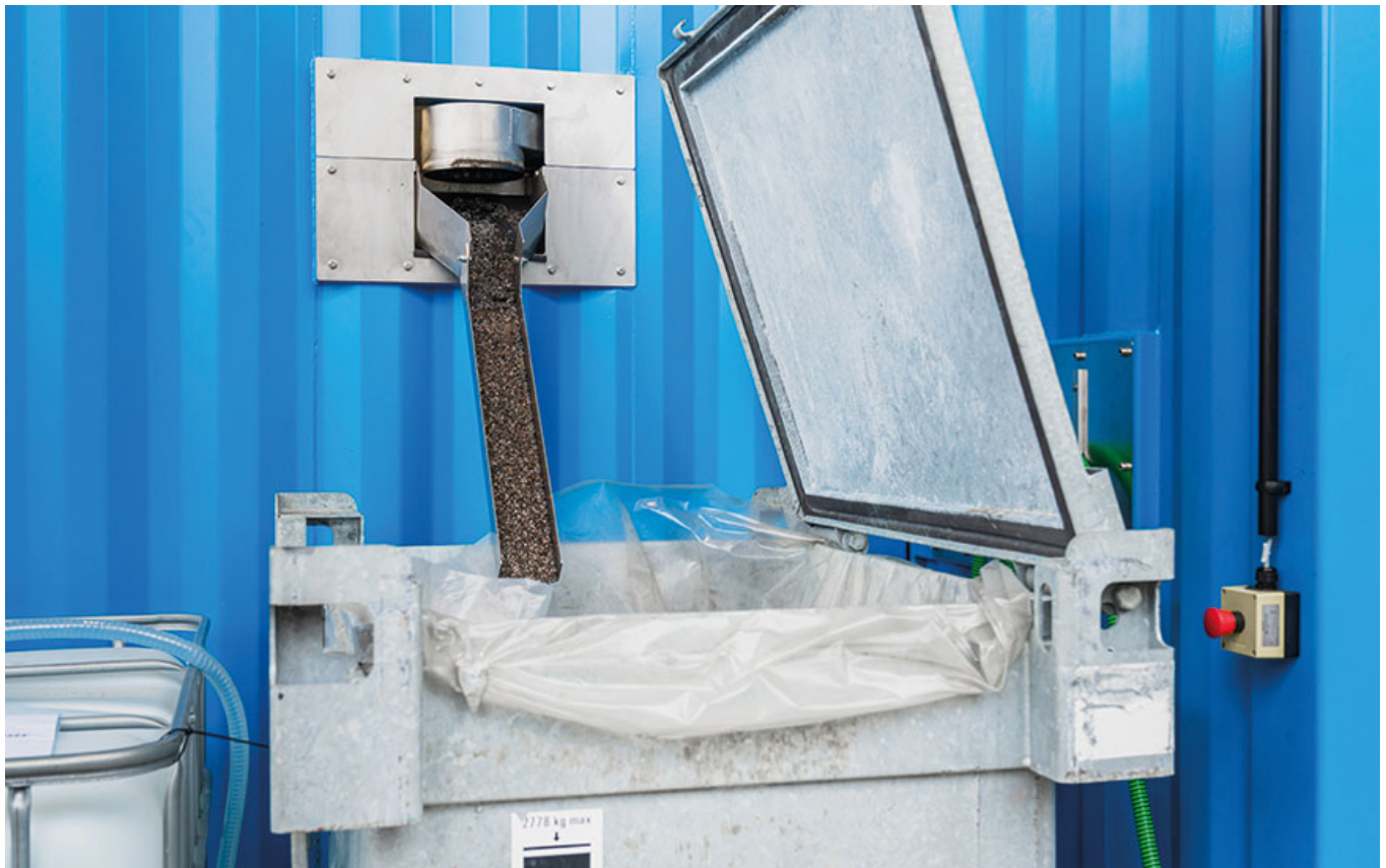
Фото. Після ударно-хвильової обробки відокремлену фракцію металу можна відокремити та вивантажити в контейнер для зберігання.
