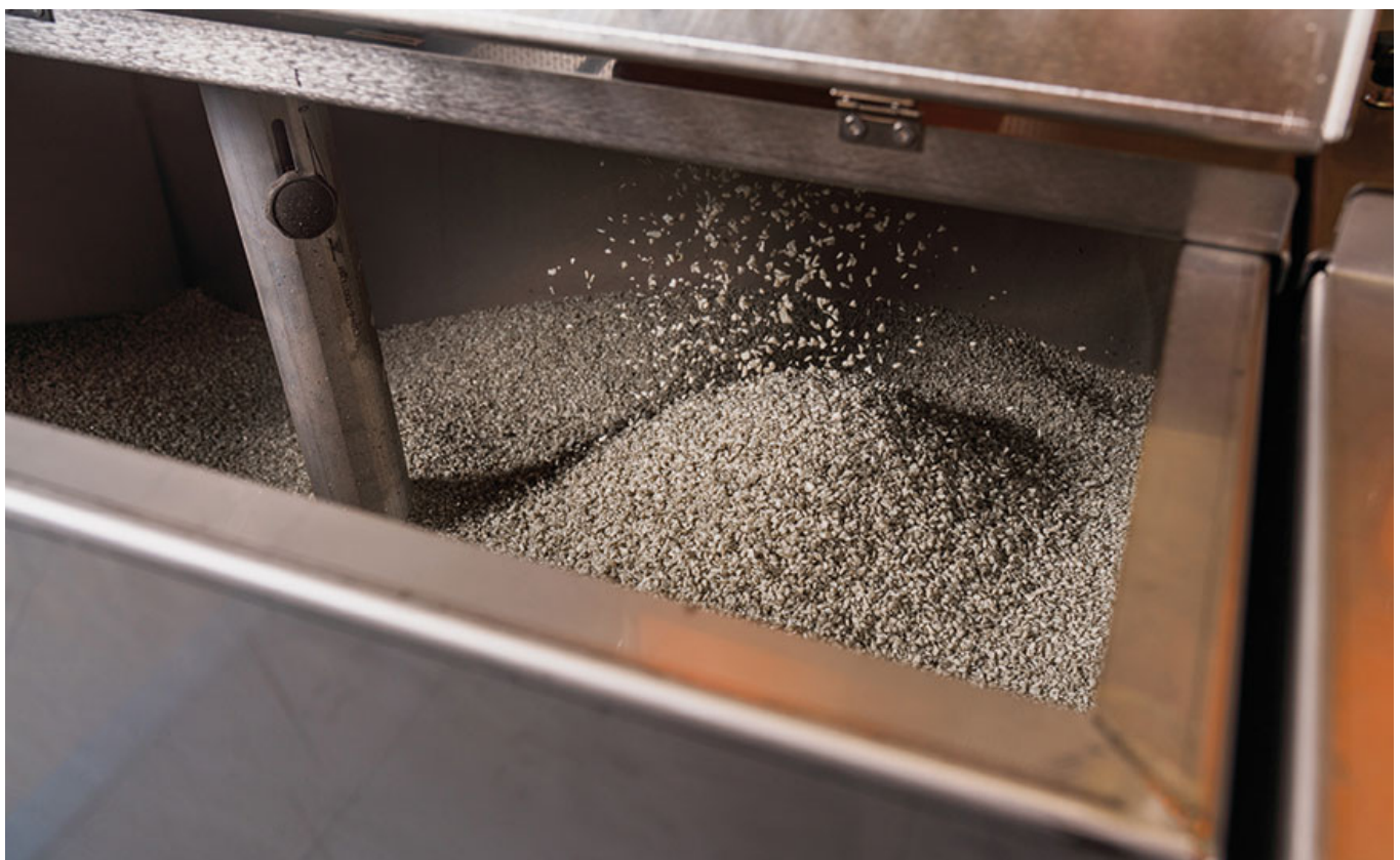
Фото. Після ударно-хвильової обробки відокремлену фракцію металу можна відокремити та вивантажити в контейнер для зберігання.
