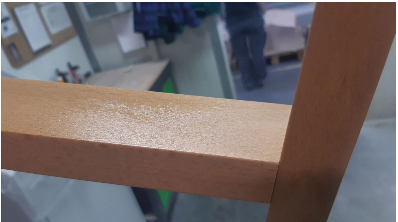
Рис. 13. Недостатнє покриття внутрішніх кутів.
