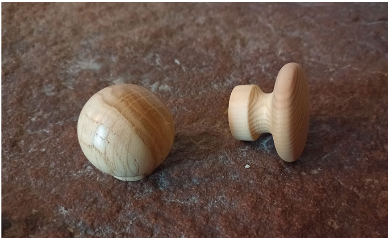
Фото. Приклад дрібних елементів, покритих прозорим лаком у барабані.
