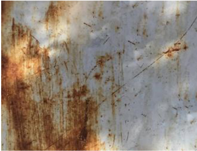
Рис. 13. Іржа на конверсійному шарі
