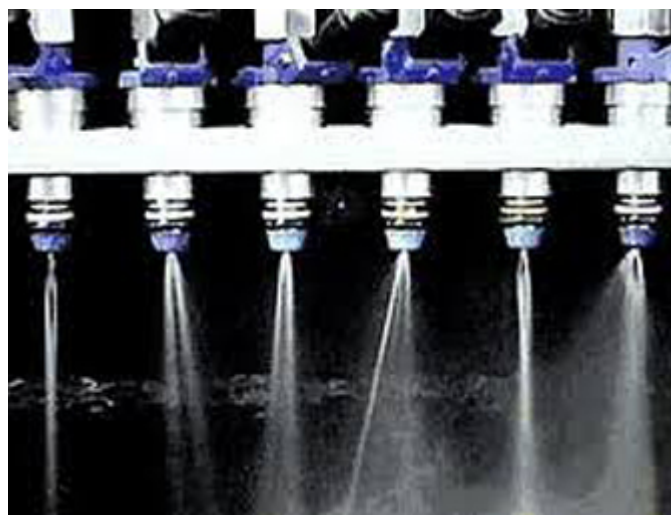
Рис. 18. Форсунки зношені – замінити їх
