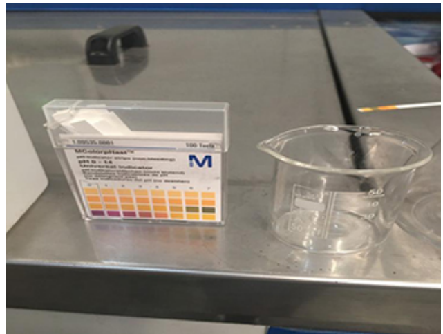
Рис. 2. Перевірити рН розчину
