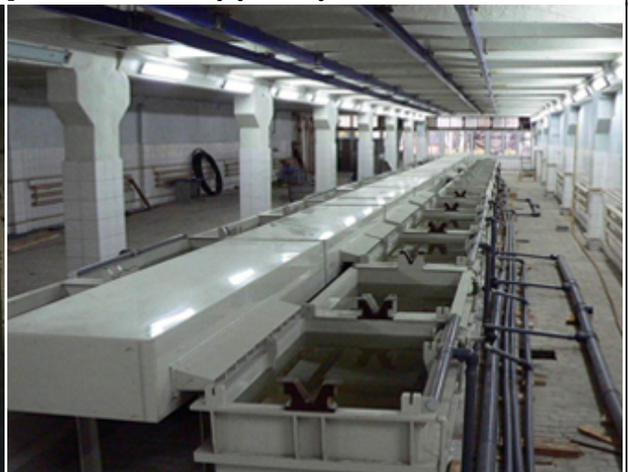
Рис. 4. Перевірити параметри ванн для знежирення
