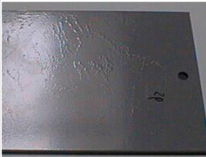
Рис. 17. Шар конверсії нерівномірний
