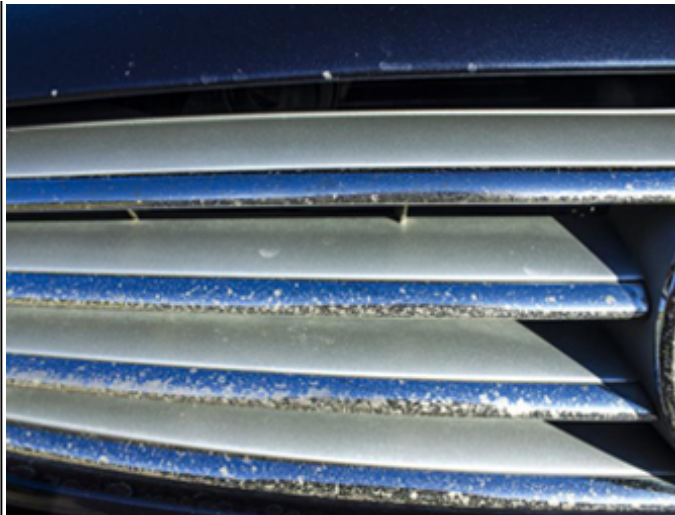
Рис. 5. Конверсійний шар плямистий
