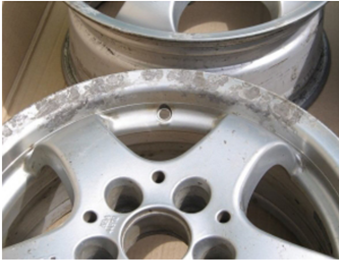
Рис. 7. Конверсійний шар стирається
