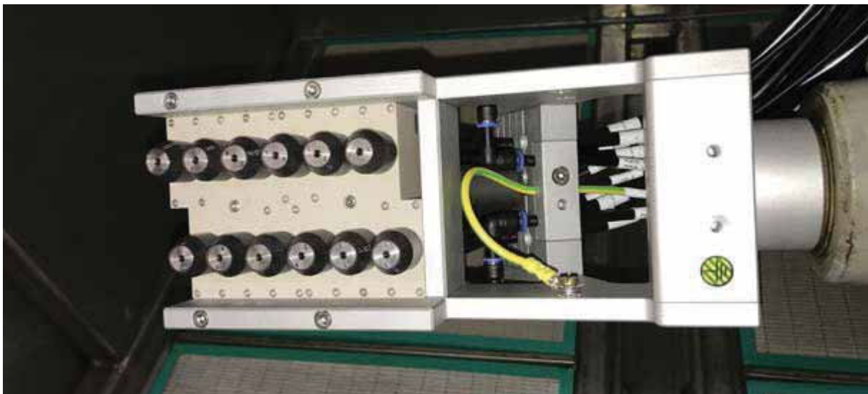
Фото 3. Запатентоване двокомпонентне кільцеве сопло забезпечує якісне рівномірне очищення. Блок, який використовується компанією Nanogate Jay Systems, обладнаний 12 соплами.
