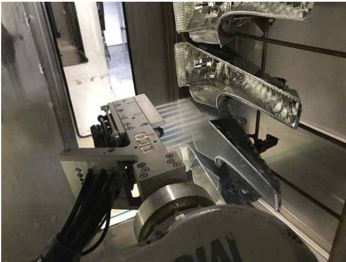
Фото 2. Системи quattroClean для очищення відбивачів за допомогою струменя сухого льоду інтегруються в лінії фарбування і металізації, і працюють під управлінням MES від компанії Nanogate Jay Systems.
