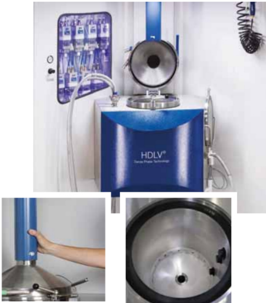
Фото 3. В центрі подачі порошкової фарби Spectrum HD забезпечена повна видимість всіх внутрішніх поверхонь для візуальної інспекції після автоматичної зміни кольору.
