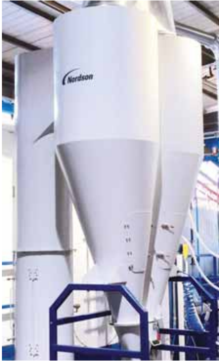
Фото 2. Дверцята на циклонах і повітряних каналах забезпечують легкий доступ
