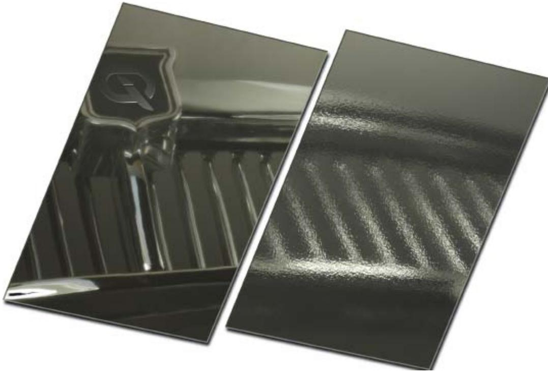
*Эффект «апельсиновой корки» может быть вызван нарушением технологии нанесения покрытия или его неоднородностью*
