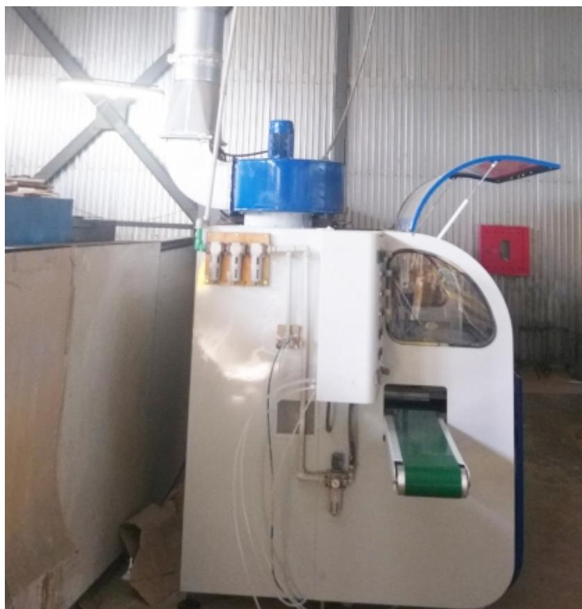
**Покрасочный станок для погонажа проходного типа предназначен для автоматической непрерывной окраски распылением ЛКМ пистолетами плоских и профильных (рельефных) изделий (любые погонажные изделия, багет, наличник, плинтус, рейки, элементы полов и перекрытий).**
