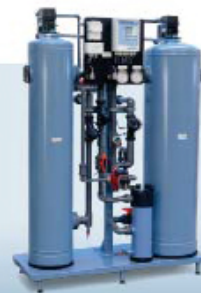
DMCE. Автоматический деминерализатор методом ионного обмена с противоточной регенерацией. Производительность до 13 м 3 /час Качество воды: 0,1-5 мкСм/см
