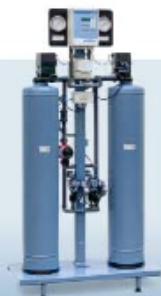
DME. Автоматический деминерализатор методом ионного обмена с прямой регенерацией. Производительность до 5 м 3 /час Качество воды: 5-20 мкСм/см
