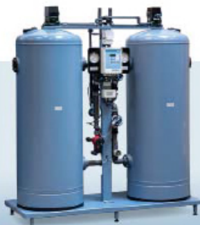
DMHE. Автоматический деминерализатор методом ионного обмена с прямой регенерацией. Производительность до 20 м 3 /час Качество воды: 5-20 мкСм/см
