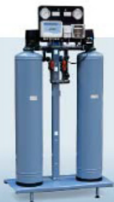
DMS. Полуавтоматический деминерализатор методом ионного обмена с прямой регенерацией. Производительность до 5 м 3 /час Качество воды: 5-20 мкСм/см
